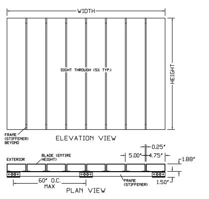
BLADE - 0.081' THICKNESS TYPE 6063-T5 EXTRUDED ALUMINUM
