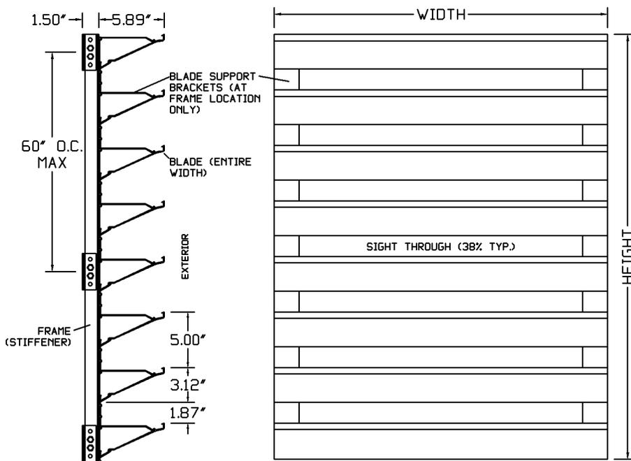
BLADE - 0.081" THICKNESS TYPE 6063-T5 EXTRUDED ALUMINUM
